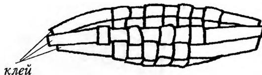
Для поделки «Лодочка» нарезать пять полосок цветной плотной бумаги шириной 1 см и четыре полоски для поперечного плетения, длиной 15 см. Переплести полоски. После этого концы длинных полосок смазать клеем, накладывая одна на одну.
