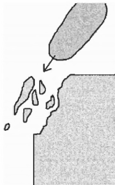
Рис. 32. Результат использования излишне жёсткого отбойника
