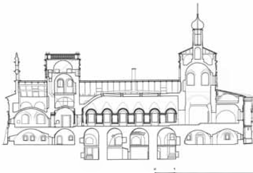
Новая трапезная. Продольный разрез. Чертёж А.О. Дмитриевой
